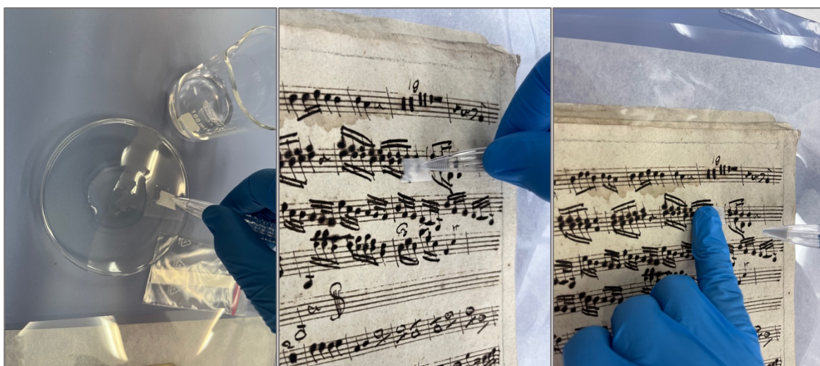
Fot. 12-14. Badanie na obecność jonów \text{Fe(II)} wskaźnikami Neevela (M.R.0006) (fot. M. Dzik).
